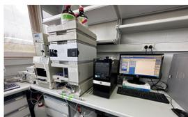
Figura 1 – Sistema de HPLC Agilent 1100 Series usado para la cuantificación
