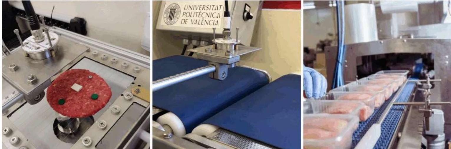
*Imagen. La tecnología de ultrasonidos sin contacto tiene pocos requisitos de instalación, lo que puede facilitar su implantación en las líneas de producción de alimentos.*
