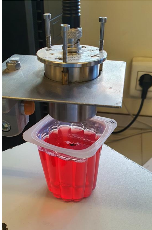
Figura 4. Medida ultrasónica sin contacto en gelatina
