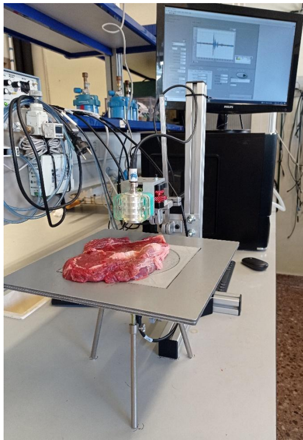
FIGURA 3. Sistema de ultrasonidos sin contacto para la medición de un filete de lomo de vacuno.
