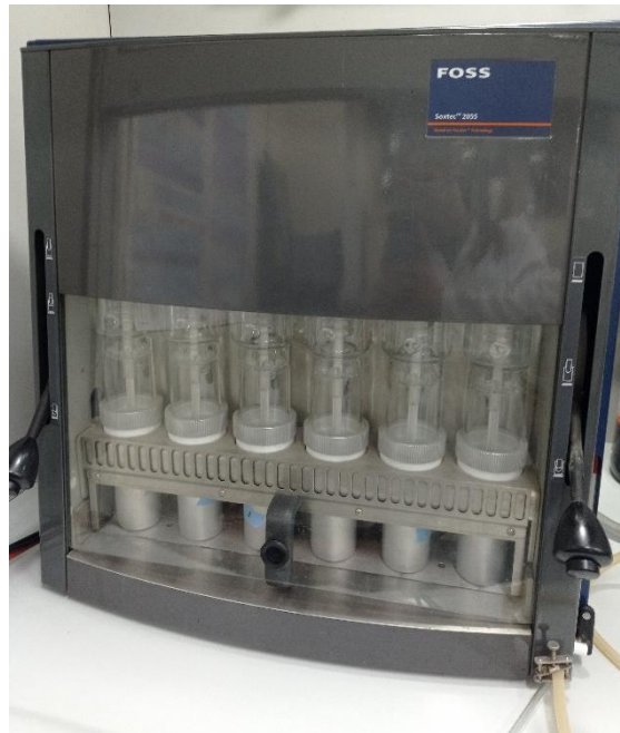
FIGURA 2. Equipo de extracción con disolventes FOSS ST255 Soxtec™
